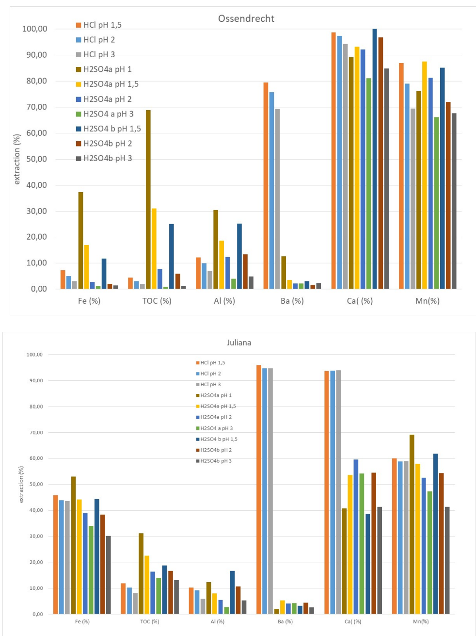
FIGUUR 3-2: Effectiviteit van extractie van slibcomponenten bij hydrolyse met behulp van verschillende zuren en bij verschillende pH-waarden. Boven slib van Ossendrecht, onder slib van Juliana. \text{H}_2\text{SO}_4 a = 96% \text{H}_2\text{SO}_4 , \text{H}_2\text{SO}_4 b = 68% \text{H}_2\text{SO}_4 .
